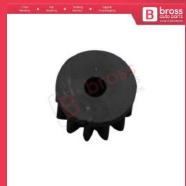
V1BGE512 Speedometer Cluster Tacho E1 12 Tooth Odometer Gear For BMW E28 E24 E30
